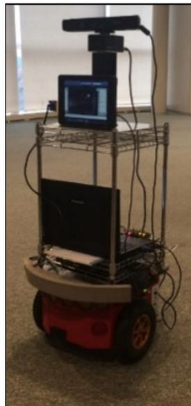
図 6.2 人の注意方向に応じて動く移動ロボット
