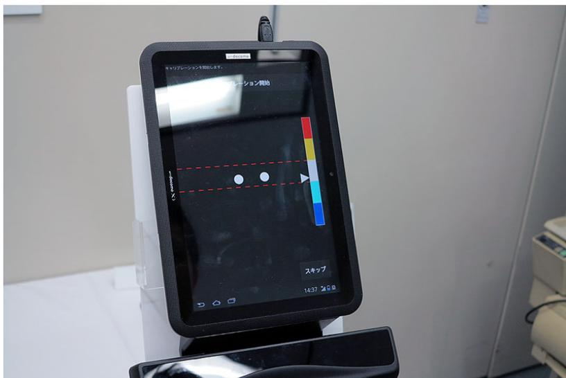
図 1.4 ibeam: 下部ユニット内に視線推定用のカメラと赤外線 LED を内蔵
